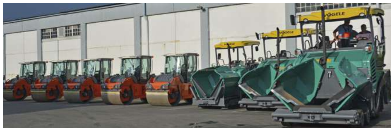
Zagrebački holding, podružnica Zagrebačke ceste u 2016. godini obnovila je strojni park s tri nova stroja za ugradnju asfalta i pet valjaka.
